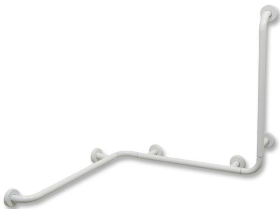
Corrimano a doppio angolo con fissaggio a muro realizzato in acetalico (materiale plastico ad altissima resistenza) studiato in collaborazione con il Politecnico di Milano per rispondere alle seguenti esigenze: 1) resistenza a carichi sul maniglione di almeno 150 kg, 2) perfetto isolamento elettrico per evitare la trasmissione di correnti vaganti. Vite di fissaggio in acciaio inox.
