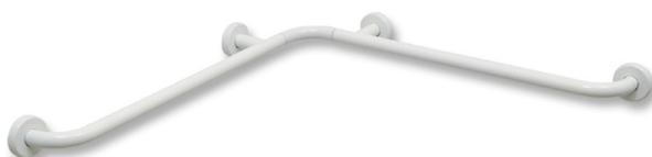
Corrimano ad angolo con fissaggio a muro realizzato in acetalico (materiale plastico ad altissima resistenza) studiato in collaborazione con il Politecnico di Milano per rispondere alle seguenti esigenze: 1) resistenza a carichi sul maniglione di almeno 150 kg, 2) perfetto isolamento elettrico per evitare la trasmissione di correnti vaganti. Vite di fissaggio in acciaio inox.
