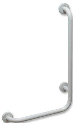
Corrimano angolare con fissaggio a muro realizzato in acetalico (materiale plastico ad altissima resistenza) studiato in collaborazione con il Politecnico di Milano per rispondere alle seguenti esigenze: 1) resistenza a carichi sul maniglione di almeno 150 kg, 2) perfetto isolamento elettrico per evitare la trasmissione di correnti vaganti. Vite di fissaggio in acciaio inox.
