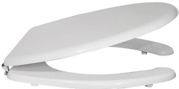
Sedile da utilizzare su codice articolo 152-C412 e 152-C400. Dimensioni: Lunghezza cm 44-46,5; Larghezza cm 37; Interasse cerniere cm 14-19. Mod. con cerniere regolabili tipo A. Sedile in legno stabilizzato, colato in poliestere. Cerniere in ottone cromato e viti di fissaggio in acciaio inox.
