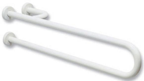
Barra di sostegno con fissaggio a muro realizzato in acetalico (materiale plastico ad altissima resistenza) studiato in collaborazione con il Politecnico di Milano per rispondere alle seguenti esigenze: 1) resistenza a carichi sul maniglione di almeno 150 kg, 2) perfetto isolamento elettrico per evitare la trasmissione di correnti vaganti. Vite di fissaggio in acciaio inox.
