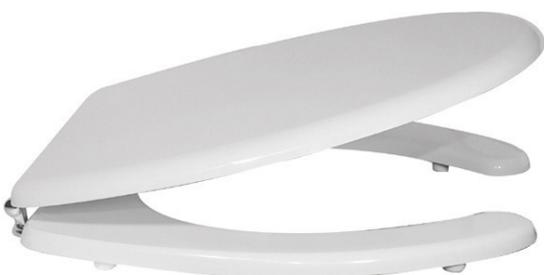
Dimensioni: Lunghezza cm 45-47; Larghezza cm 38; Interasse cerniere cm 14,5-19,5. Mod. con cerniere regolabili tipo A. Sedile in legno stabilizzato, colato in poliestere. Cerniere in ottone cromato e viti di fissaggio in acciaio inox. Idoneo per vaso codice 152-D400.
