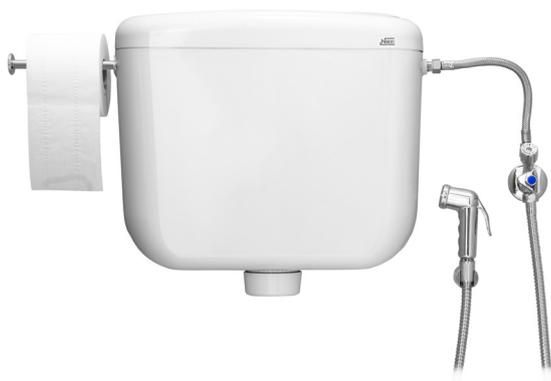
Cassetta di risciacquo multifunzione. Allacciamento idrico laterale del galleggiante. Pulsante doppio scarico. Attacco rubinetto per regolazione di apertura/chiusura del flusso d'acqua e rubinetto per la regolazione della pressione dell'acqua nella doccetta. Accessoriata di portacarta cromato laterale e doccetta shut-off.
